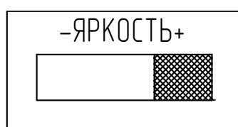
Рисунок 2.15 – Установка яркости индикатора
